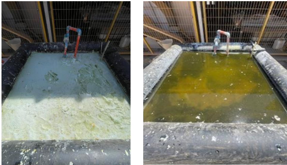
Piscina escala piloto: A la izquierda se muestra piscina con solución expuesta a evotranspiración. A la derecha se muestra piscina con adición de refino y/o agua, junto con movimiento de solución.
